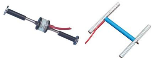
Medida de la deformación en hormigón Rango: 3.000 \mu deformaciones (También disponibles rangos mayores) Sensibilidad: 1% \mu deformación
