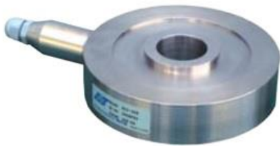
Medida de carga en anclajes, tirantes y bulones Capacidad (ton.f.): 50, 75, 100, 150, 200 Exactitud: \pm 1\% F.E.
