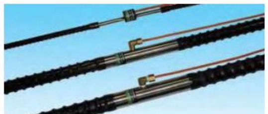
Medida de tensiones en la armadura de estructuras de hormigón. Sensor: Cuerda vibrante Rango: 4.800 kg/cm 2 Exactitud: \pm 0,1\% F.E. No linealidad: \pm 0,5\% F.E.
