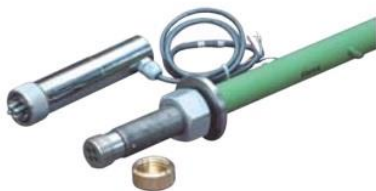
Evaluar la efectividad de la longitud del anclaje y medir los esfuerzos y su distribución dentro del bulón. Capacidad de carga: 250 kN Puntos de medida: 4 Longitud total (m): 2, 3, 4, 5, 6.
