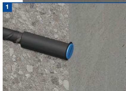
El manguito se suele suministrar fijado a la barra de armado, listo para ser instalado y fraguado en el hormigón.
