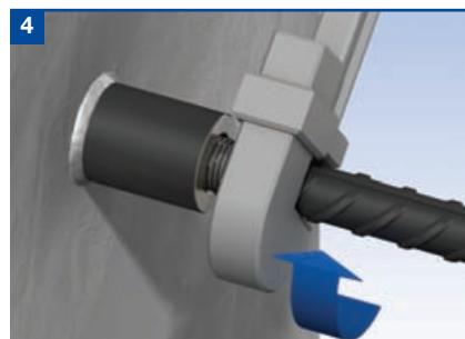
Para asegurar la instalación, apriete la junta con el par correcto utilizando una llave calibrada en la barra de continuación. Los pares de apriete correctos están representados en la tabla.
