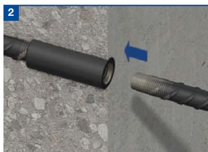
Con el hormigón fraguado y listo para continuar, retire la tapa de plástico del manguito. Coloque la barra de continuación en el manguito y gire la barra para insertarla en el manguito.
